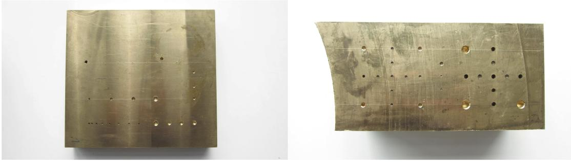
**Abb. 3** Links: Testblock WA2, Abmessungen 310 x 285 x 50 mm<sup>3</sup>; rechts: Testblock WB4, Abmessungen ca. 250 x 125 x 115 mm<sup>3</sup> mit FBB der Durchmesser 2 mm bis 8 mm.
