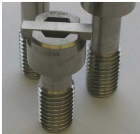
Abb. 11: Innensechskantschraube mit Sicherungsstift, eingebaut in 7 Westinghouse 4-loop Reaktoren (USA)
