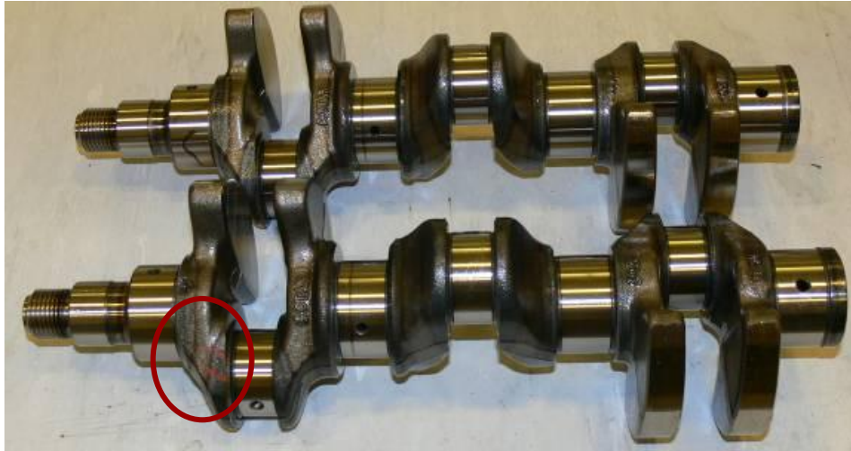
Abb. 1: Kurbelwelle mit Defekt in MT-Prüfung
