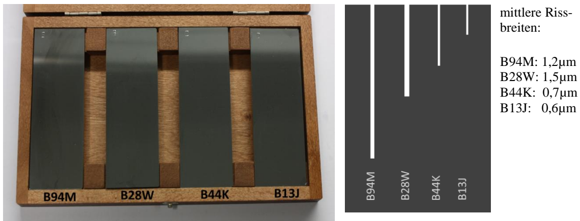
Abbildung 7: Links: Fotografie der vier Kontrollkörper mit 50, 30, 20 und 10 \mu\text{m} Risstiefe. Rechts: Maßstabsgetreue Darstellung der mittleren Rissgeometrie für die unterschiedlichen Kontrollkörper.
