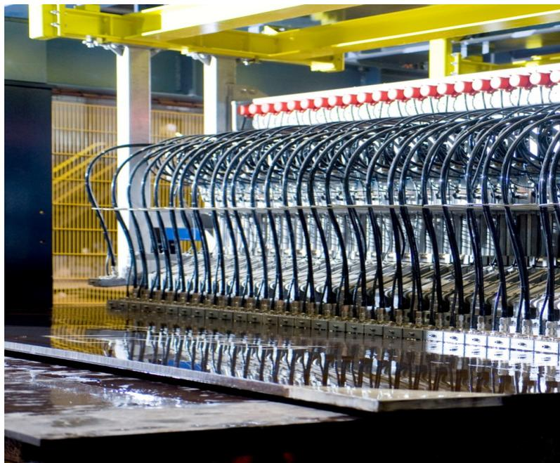
Abb. 2: Anordnung der Prüfkopfstanstellenmechanik im Flächenprüfwagen
