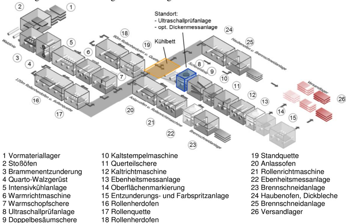
Abb. 1: Anlagenintegration in die Scherenstrecke, Grobblechwalzwerk Hüttenheim [3]
