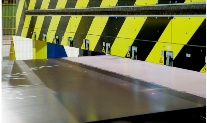
Abb. 3: Aufbau der optischen Dickenmessanlage
