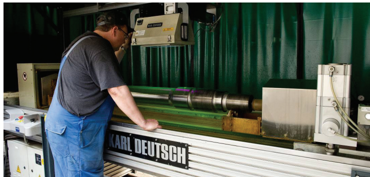
Bild 5. Motorisierte Drehvorrichtung zur Betrachtung der Welle unter UV-Licht. Die UV-Leuchte wird leichtgängig in die richtige Prüfposition gebracht
