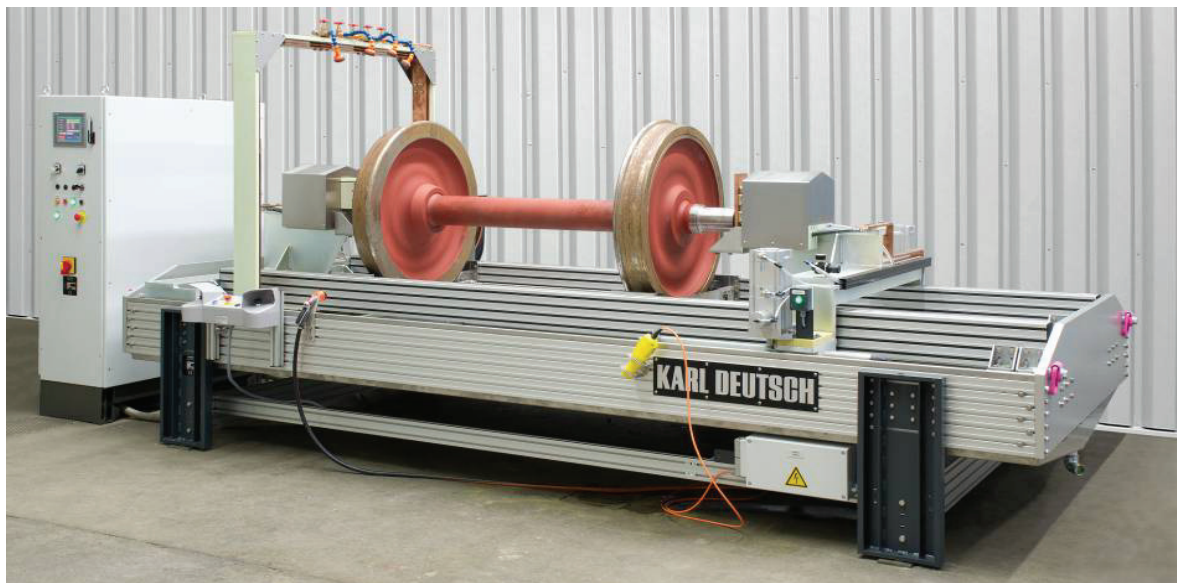
Bild 11. Prüfung von Eisenbahnwellen mit montierten Rädern
