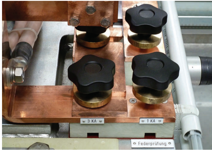
Bild 9. Umklemmvorrichtung zur alternativen Prüfung von Federn und sonstigen Bauteilen
