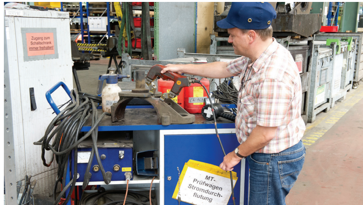
Bild 1. Mobile Magnetpulver-Rissprüfung mit Handjoch bei der Deutsche Bahn AG in Krefeld
