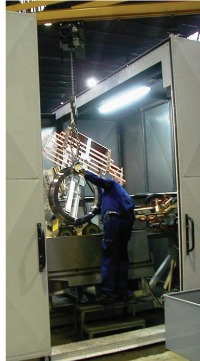
Bild 15. Kranbeladung der Prüfmaschine für Räder und Radreifen bei der Bochumer Verein Verkehrstechnik GmbH
