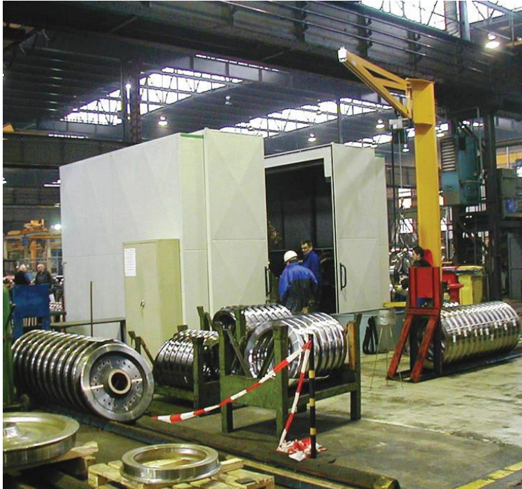
Bild 15. Kranbeladung der Prüfmaschine für Räder und Radreifen bei der Bochumer Verein Verkehrstechnik GmbH
