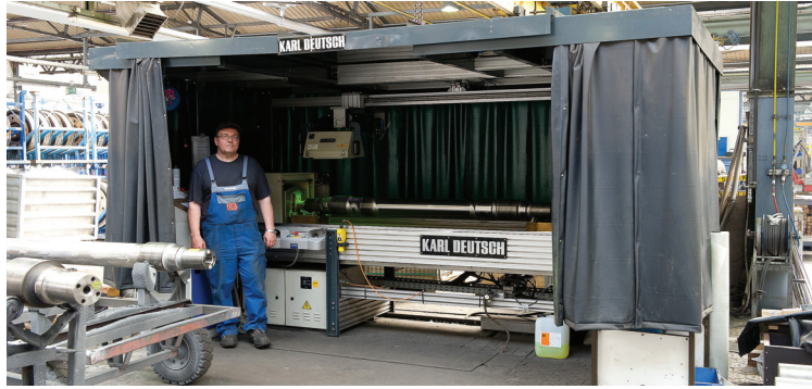
Bild 3. Prüfung von Eisenbahnwellen bei der DB Fahrzeuginstandhaltung GmbH, Werk Krefeld
