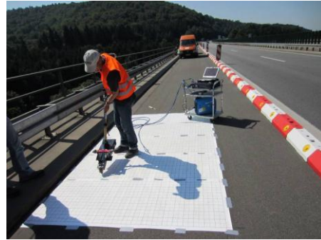
Abb. 12: Aufnahme einer Messlinie in Fahrbahnrichtung (links); Aufnahme eines Messfeldes mit Hilfe einer Schablone (rechts)
