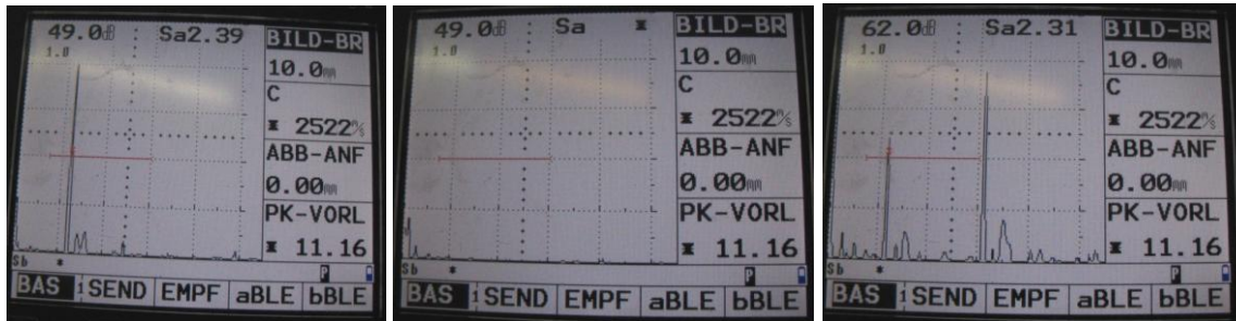
Abb. 2: Prüfkörper 2.2 AR Ultraschallprüfung (A-Scan) im Bereich partiell ohne Dichtband (links), im Bereich mit Dichtband (Mitte) und im Bereich der Muffenverklebung (rechts)
