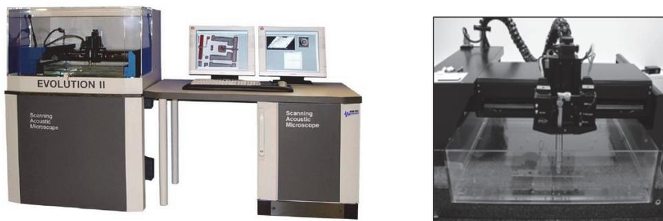
Abbildung 6: Scannendes Akustisches Mikroskop (links) und SAM-Scaneinheit (rechts).
