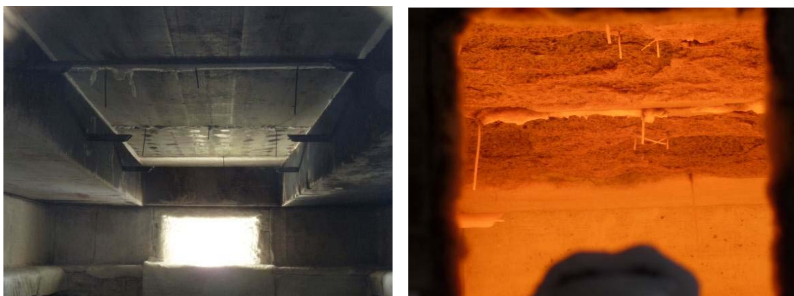
Abb. 2: Blick ins Ofeninnere, links vor Versuchsbeginn mit intakten Probekörpern, rechts während des Versuchs mit bereits geschädigten Probekörpern.
