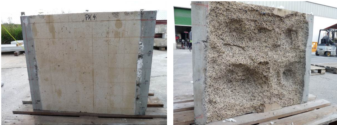
Abb. 3: Probekörper nach den Brandversuchen, links mit PP-Fasern, rechts ohne..
