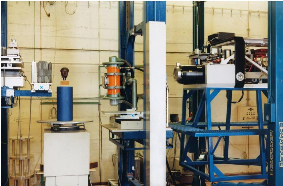
Abb. 3 Der Kopf von Kythera auf dem BAM Tomograph (2004) mit Heimann Detektor und Raytech 12MeV Linearbeschleuniger, rechts.
