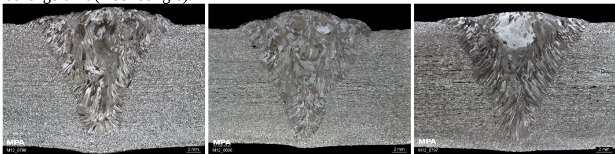
Abbildung 6: Schweißnähte mit gepulstem WIG-Lichtbogen geschweißt (li) 50 Hz (Mitte) 100 Hz (re) 500 Hz
