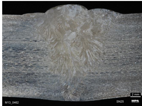
Abbildung 9: Gefüge unter mechanischen Vibrationen, induziert durch einen Shaker ( f = 100 Hz, Amplitude = 0,5 mm) erstarrt.
