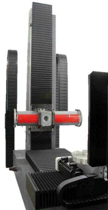
Abbildung 1: links: Abschwächung von Röntgenstrahlung in Abhängigkeit von der Energie für verschiedene Materialien; rechts: RayScan 600 CT-System mit 600 kV Minifokus-Hochleistungsrontgenröhre
