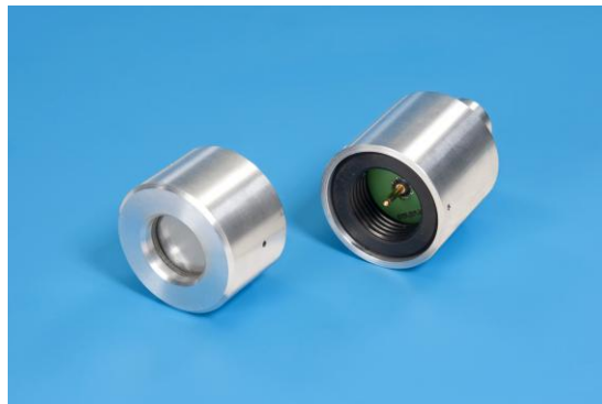
Abbildung 1. Luftultraschall-Prüfkopf mit einem Wandler aus zellulärem Polypropylen. Der Modulare Aufbau ermöglicht einen Austausch des Wandlers (links), mit der elektrischen Anpassung für den Sender oder Empfänger in dem anderen Modul (rechts).
