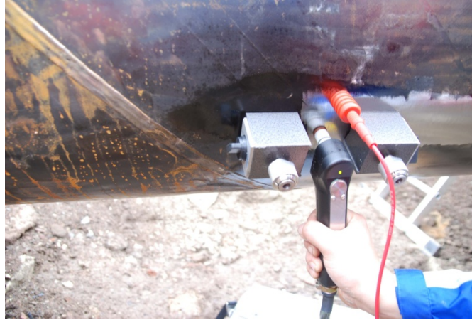
Bild 7. Vorbereitung der Messstelle durch elektrolytisches Ätzen
