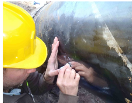
Bild 8. Ultraschallmessungen an einer Gashochdruckleitung
