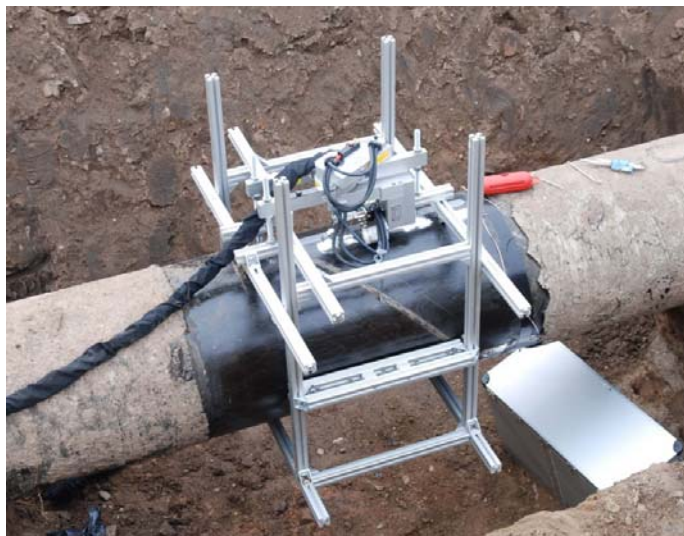
Bild 9. Vorrichtung zur genauen Positionierung des Röntgendiffraktometers
