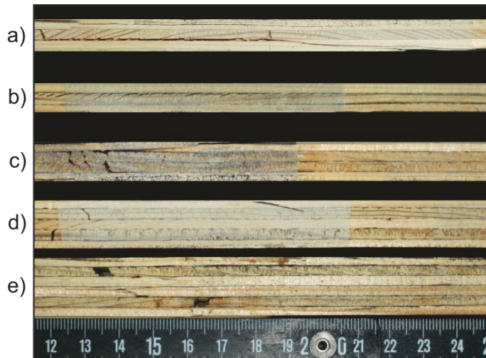
Abbildung 4. Bruchbilder der Sperrholz-Typen: a) Labor 3 (ohne Schälrisse), b) Industrie 3, c) Industrie 4, d) Industrie 5, e) Industrie 6
