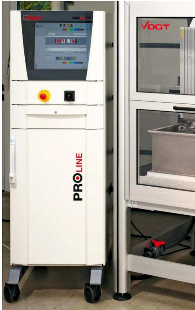
Bild 6: Bedienerpult für in-/offline Prüfstand
