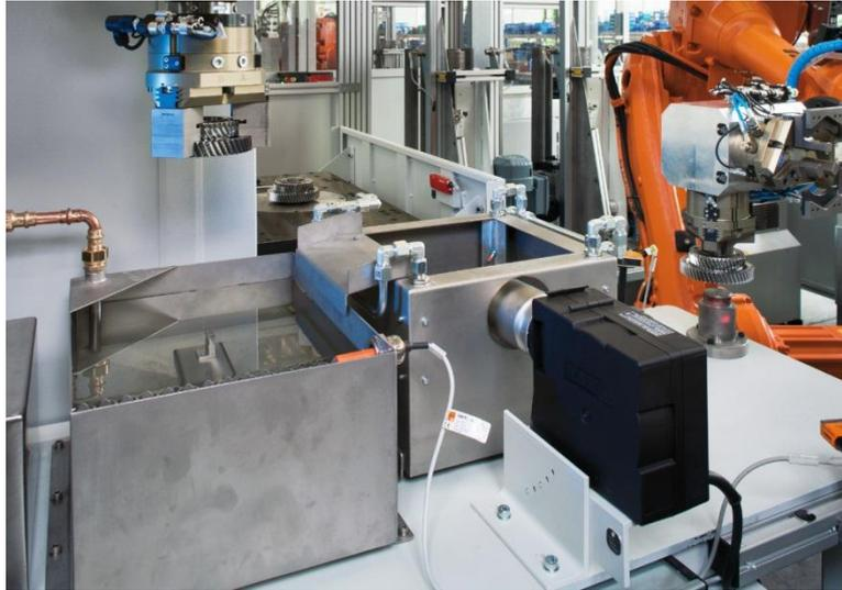
**Bild 4:** Inline Ultraschallprüfsystem
