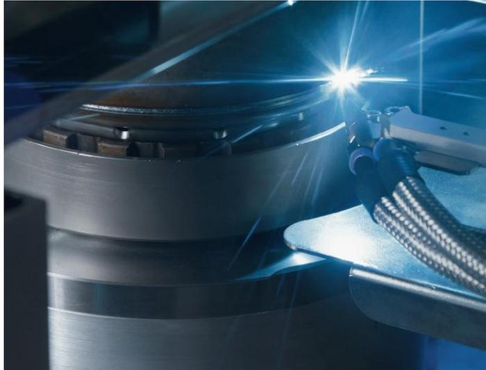
**Bild 2:** Inline Laserschweißprozess
