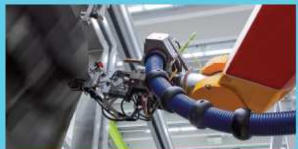
komplexes Tool zur Prüfung von Stringern (ohne Tauchen)
