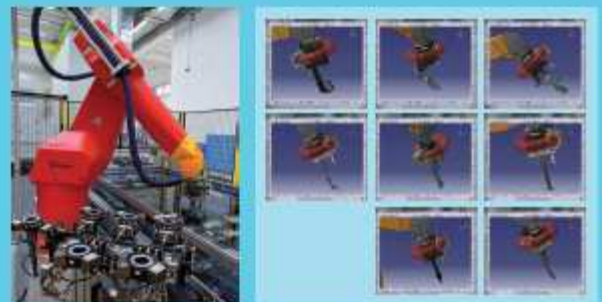
Wechselsystem für sieben tools (oben), in 12 Konfigurationen (Auswahl rechts)
