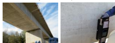
▶ Brückensicht und Messung mit multistatischem Array
