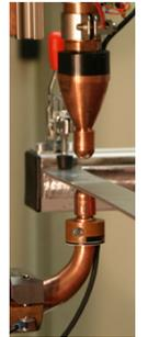
Abb. 1: Schweißzange mit Sender (oben) und Empfänger (unten)
