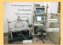
Das linke Bild zeigt den an der BAM entwickelten Prüfstand bestehend aus dem Scanner und einer Laufzeitapparatur. In dem unteren Bild sind schematisch die Systemachsen des Scanners abgebildet. Die Oberfläche der Halbkugel kann vollständig automatisch abgetastet werden.
