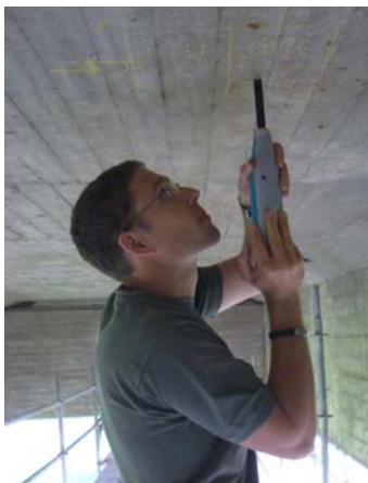
(a) (b) Abbildung 1 (a) Messung der Rückprallzahl mit einem Rückprallhammer über Kopf an einer Brücke. (b) Wirkungsweise der Karbonatisierung auf die Messung der Rückprallzahl: Durch die Karbonatisierung des Betons an der Oberfläche (Würfel B) werden im Vergleich zum nicht karbonatisierten Beton (Würfel A) größere Rückprallzahlen (hier R-Wert) gemessen. Die Betondruckfestigkeit im Inneren des Betons wird dadurch überschätzt.
