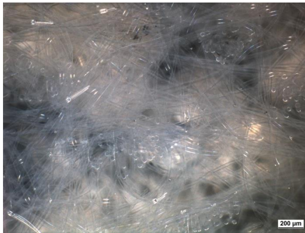
Abb. 13: Bild der EP-Nadelfilz Probe mit Stereomikroskop Leica M205A
