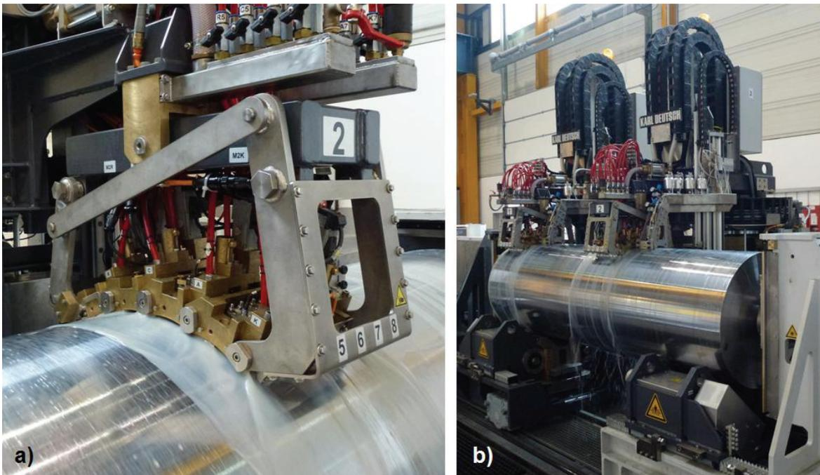
**Bild 6.** Prüfkopfhalter zur Stabstahlprüfung, **a)** jeder Prüfkopfhalter enthält eine Matrix aus 4 x 4 Prüfköpfen, **b)** zwei separate Prüfkopfhalter wurden zur besseren akustischen Entkopplung verwendet
