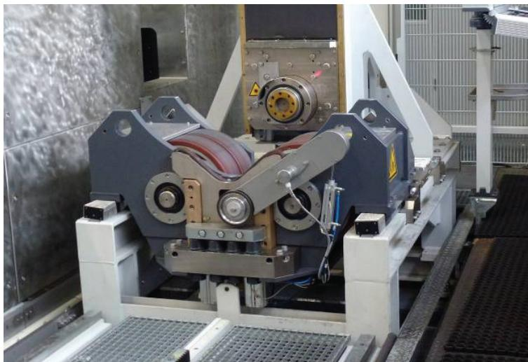
**Bild 3.** Drehrollenstation mit Dämpferbaugruppe ausgelegt für hohe Bauteilgewichte
