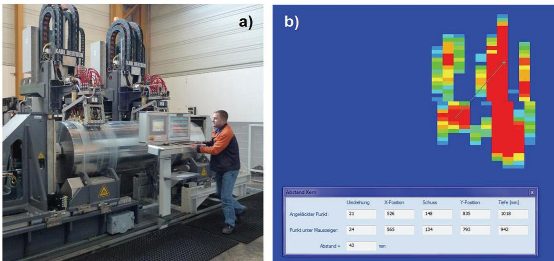
**Bild 7.** Auswertung der Prüfergebnisse, **a)** Betrachtung der Prüfergebnisse an fahrbarem Bedienpult (verfügbar an beiden Prüfstationen), **b)** Prüfergebnis als C-Bild mit der 3D-Abstandbestimmung zwischen zwei Fehlstellen (wobei sich die rechteckige Schwingergeometrie in länglichen Pixeln zeigt)
