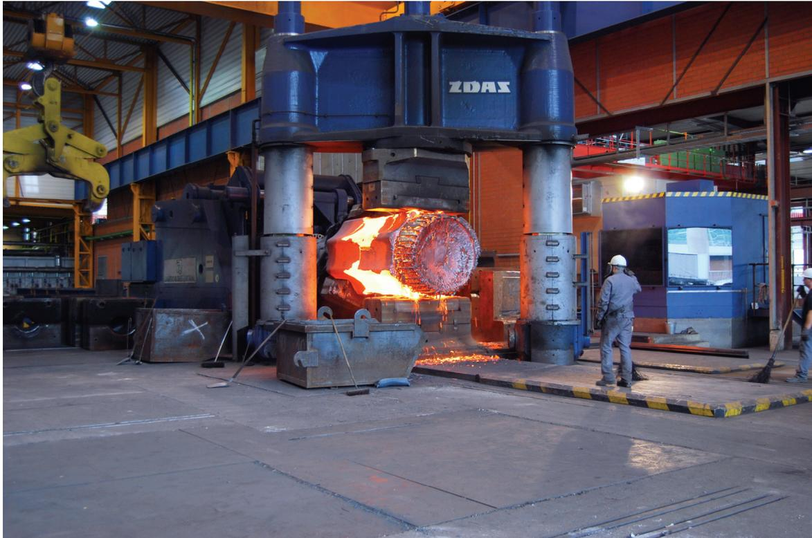
**Bild 1.** Leistungsfähige Presse (4000 t) bei der BGH Edelstahlwerke Siegen GmbH
