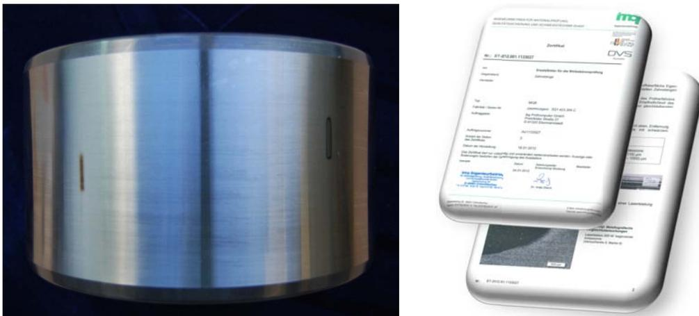
Abb. 3: Masterprobe eines Wälzlager- Außenringes und Zertifikat
