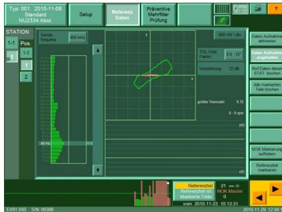
Abb. 4: Zulässiger Anzeigebereich (Toleranzfeld) für die Wirbelstromprüfung der Gut-Menge – QuaSor E/ eddyvisor für einen Bandpass.
