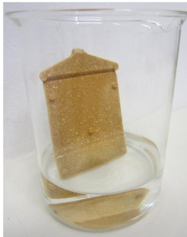
**Abbildung 4:** Zur Befeuchtung wurde eine spritzgegossene Platte aus Polypropylen gefüllt mit 70 Gew.-% Holzmehl für 11 Tage teilweise in Wasser getaucht.
