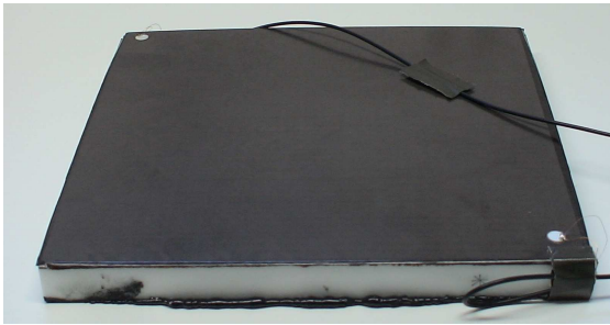
Bild 11: Schaum-Sandwich-Bauteil mit einer Aluminium- und einer CFK-Deckschicht (DLR)
