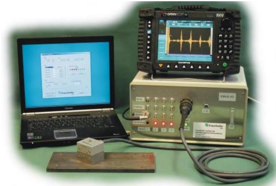
Abbildung 3.2 Ultraschallprüfung mit EMUS-VG in Kombination mit konventionellem Ultraschallgerät, EMUS-Prüfkopf und Parametrier-Laptop
