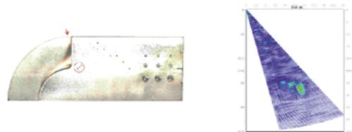
links: PAUT Testkörper mit Querbohrungen (roter Kreis), Pfeil zeigt die Positionierung des Prüfkopfes
