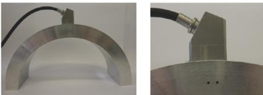
Gefertigter Prüfkopf auf einem Testkörper (Radius 100 mm)
